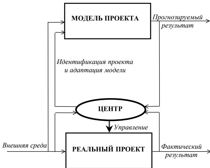
Рис. 2. Структура системы оперативного управления проектом
