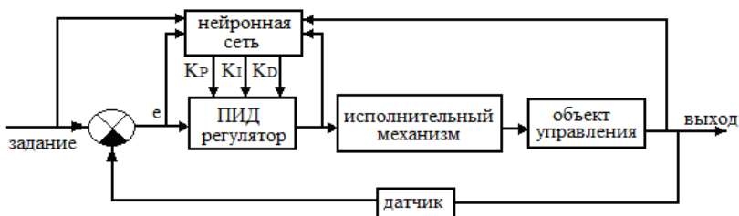
Рис. 1. Схема управления с нейросетевым оптимизатором параметров регулятора
