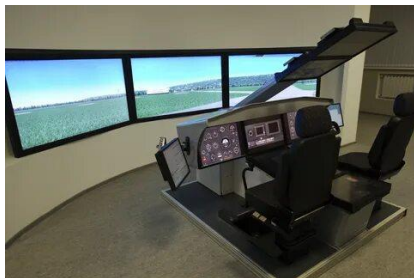
Рис. 7. Пилотажный АТ для обучения лётчика управлению ЛА с тремя 3D-индикаторами позволяющему лётчику пилотировать модель ЛА наблюдая линию горизонта
