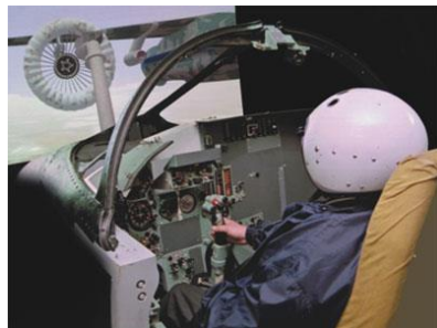
Рис. 8. Специализированный АТ для обучения лётчика дозаправки в воздухе с ИВО с двухканальным 3D-индикатором с диспаратными очками
