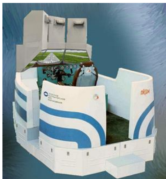
Рис. 5. Кабина АТ с ИВО с составным 3D^{(V_2)} -индикатором из трёх безочковых одноканальных 3D^{(V_2)} -индикаторов с «узким зрачком»
