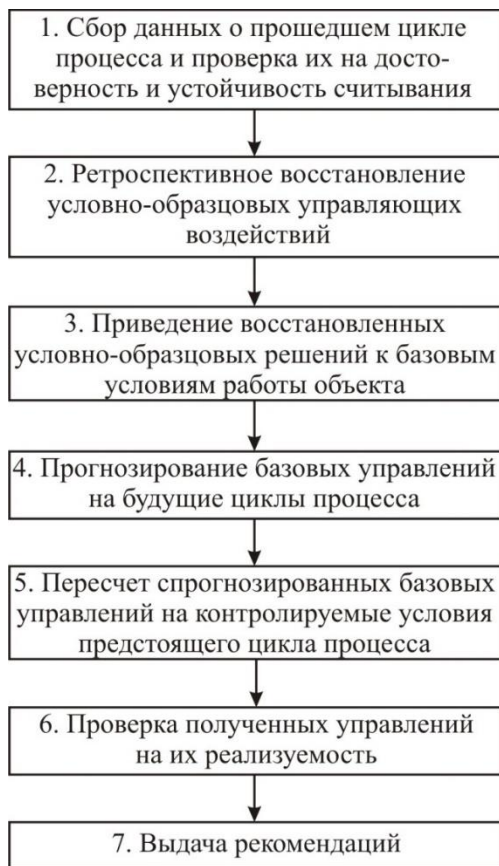
Рисунок 4 – Укрупненная блок-схема восстановительно-прогнозирующего алгоритма
