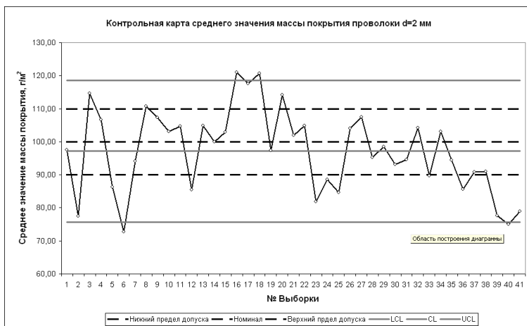
Рис. 2. Контрольная карта процесса нанесения покрытия на проволоку диаметром 2,0 мм
